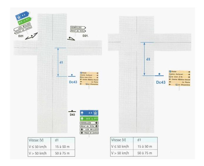
Le panneau Dc43 est situé entre le D43 et le carrefour. Il sera implanté à 15 mètres minimum en amont du carrefour (d1) et sera éloigné suffisamment du D43 pour ne pas perturber la lecture et la lisibilité des différents ensembles.
